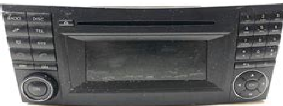
NTG2.5 Audio20/50 APS(front panel)
